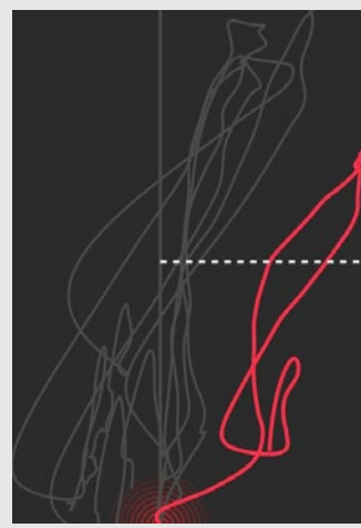
Görsel 2. Kompensatörsüz tabanca ile tabanca namlusunun atış sonrası izlediği yol ve geri tepme genişliği. Kırmızı çizgi, atış sonrası namlu hareketini, beyaz kesik çizgi ise namlunun x ekseninde aldığı mesafeyi gösteriyor.
