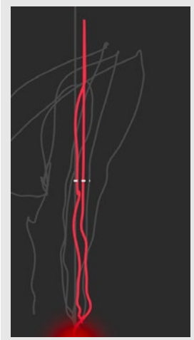
Görsel 3. CANİK TTI COMBAT ile yapılan atıştaki geri tepme genişliğinde, kırmızı çizgi atış sonrası namlu hareketini, beyaz kesik çizgi ise namlunun x ekseninde aldığı mesafeyi gösteriyor.
