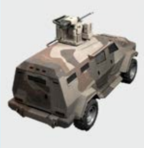
Venom LR 30x113 mm Otomatik Top ile donatılmış TRAKON Uzaktan Kumandalı Silah İstasyonu (RCWS), çeşitli platformlar üzerindeki gösterimi TRAKON Remote Controlled Weapon Station (RCWS) equipped with Venom LR 30x113 mm Automatic Cannon, demonstration on various platforms
