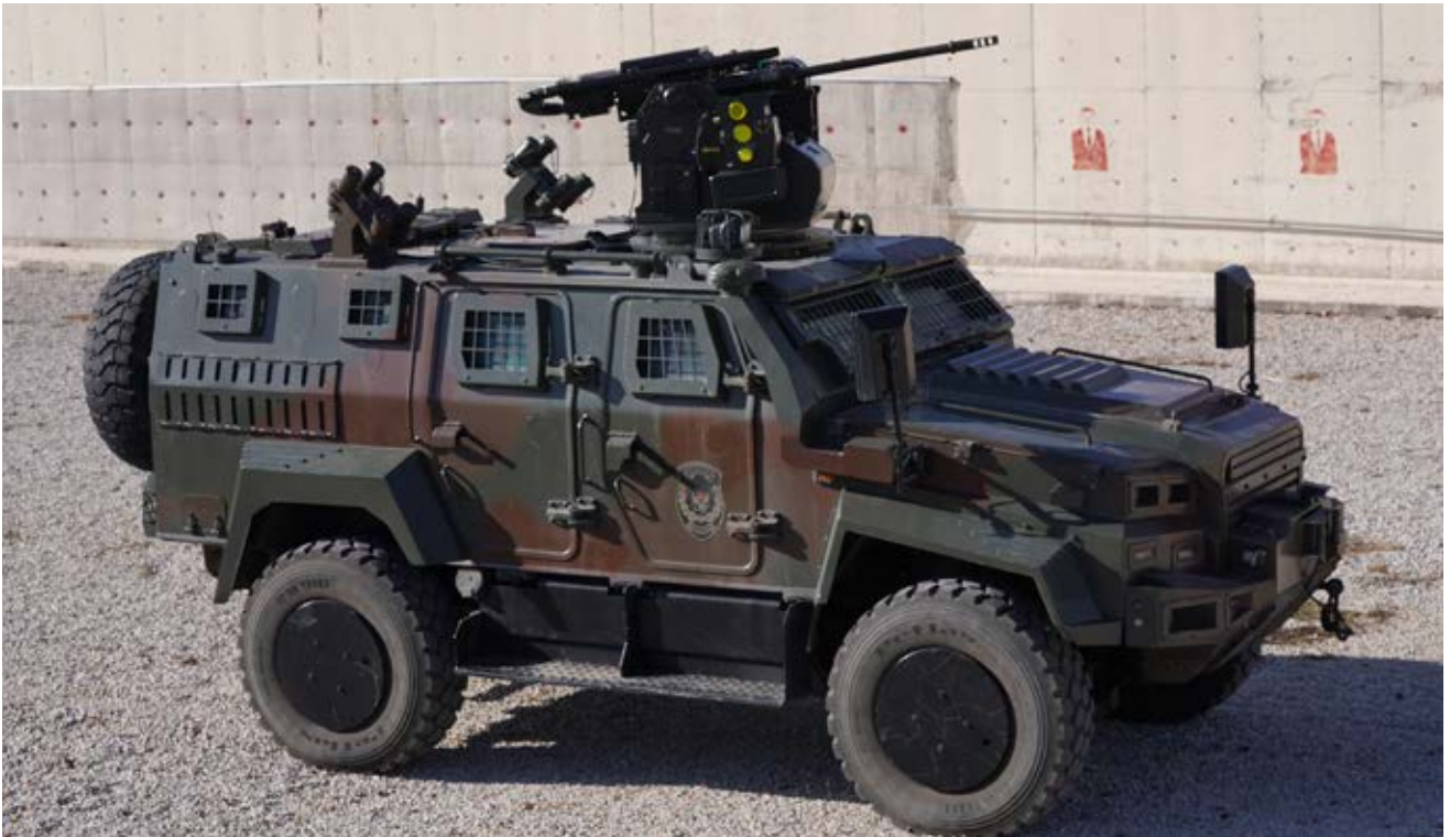
SYS Grup- UNIROBOTICS TRAKON 30 Uzaktan Komutalı Silah Sisteminin EJDİR-1 Aracına Entegrasyonu- Özel Harekat Başkanlığı DemolIntegration of SYS Group- UNIROBOTICS TRAKON 30 Remote Controlled Weapon System to EJDİR-1 Vehicle - Special Operations Directorate Demo
