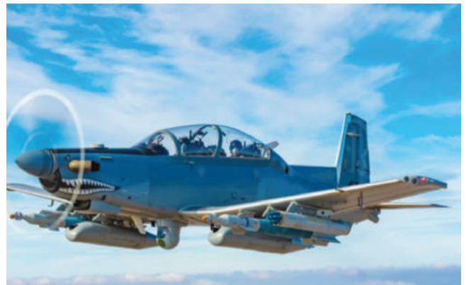
Lazer güdümlü bomba ve FFAR podlarının yanında 12,7mm makineli tüfek podu ile silahlandırılmış AT-6B Wolverine LAA AT-6B Wolverine LAA, armed with 12.7mm machine gun pods next to laser-guided bomb and FFAR pods
